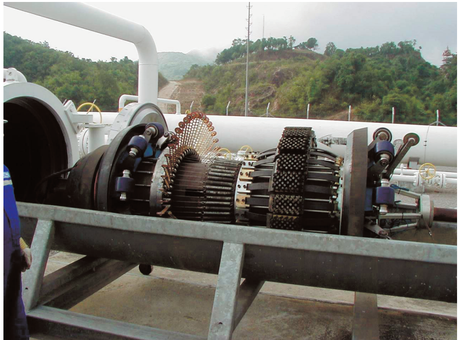
Insertion of the „Pig“
